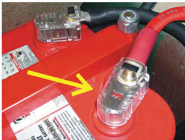
شکل ۱۹-۲- مورد استفاده تلق محافظ قطب‌های باتری
