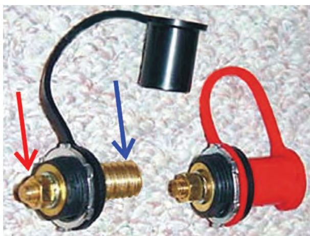
شکل ۱۴-۲- واسطه‌ی اتصال ترمینال باتری
