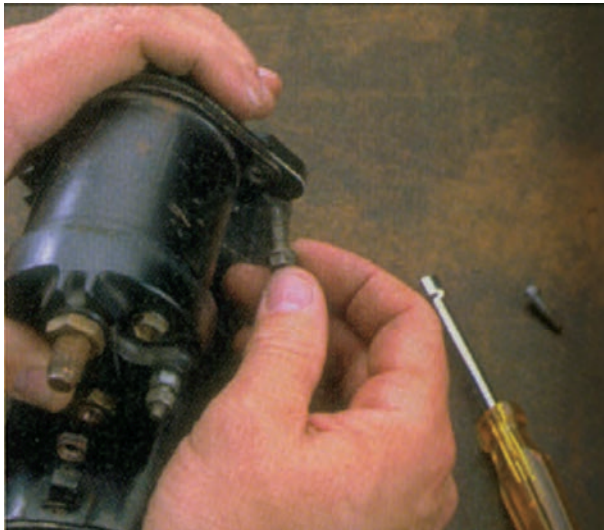
شکل ۸-۵۳ – بیرون آوردن پیچ‌های اتومات
