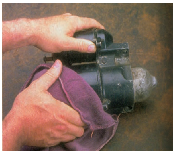
شکل ۸-۵۰ - تمیز کردن استارت
