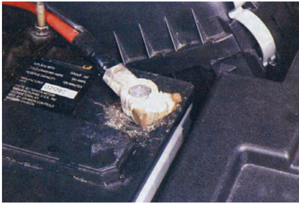
شکل ۸-۳۱ سولفات شده شدن اتصال قطب باتری
