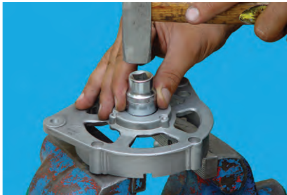
شکل ۶۹-۷ - بیرون آوردن بلبرینگ
