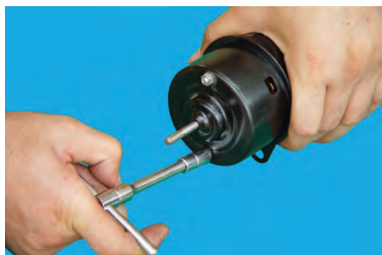
شکل ۴-۴۴- باز کردن پیچ‌های پوسته‌ی موتور
