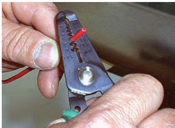
شکل ۴-۶۴ - جدا کردن عایق سیم‌ها
