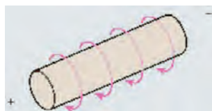
شکل ۷-۳ در اطراف سیم هادی حامل جریان، میدان مغناطیسی به وجود می‌آید.
