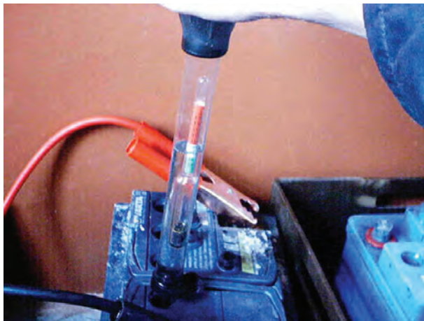
شکل ۱-۵۳- کنترل غلظت الکترولیت
