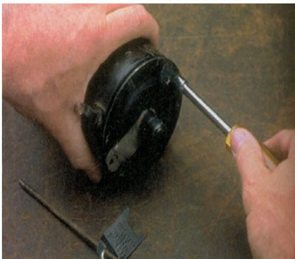
شکل ۸-۵۵ – باز کردن پیچ‌های اتصال درپوش به بدنه
