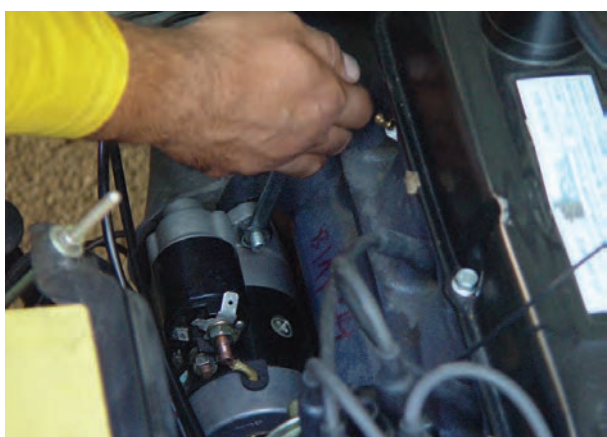
الف – باز کردن پیچ‌های استارتر
