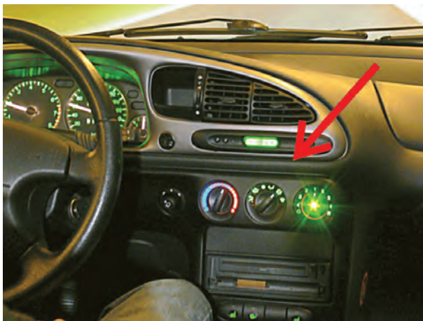
شکل ۵۳-۴- روشنایی سوئیچ نصب شده در پانل جلوی راننده
