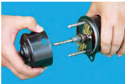
شکل ۴۵-۴- جدا کردن پوسته‌ی موتور
