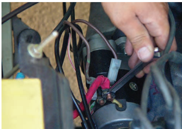
شکل ۸-۴۸ – جدا کردن اتصالات الکتریکی استارتر
