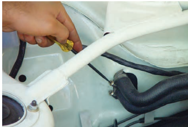
شکل ۴-۳۱- باز کردن لوله‌های آب رادیاتور بخاری
