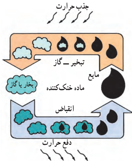
شکل ۵-۳- مراحل تغییر ماده خنک کننده
