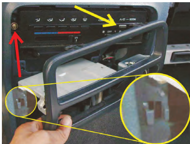
شکل ۳۸-۵ باز کردن قاب سوئیچ‌ها
