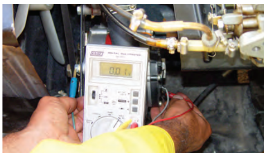
شکل ۷۲-۷ - اتصال ولت‌متر بین ترمینال B و بدنه
