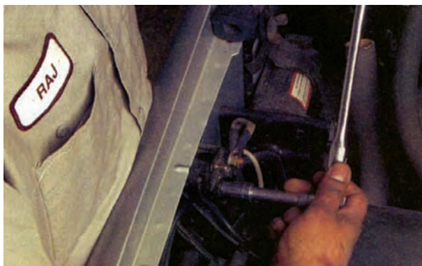
شکل ۸-۴۵ - اندازه‌گیری افت ولتاژ رله‌ی استارت
