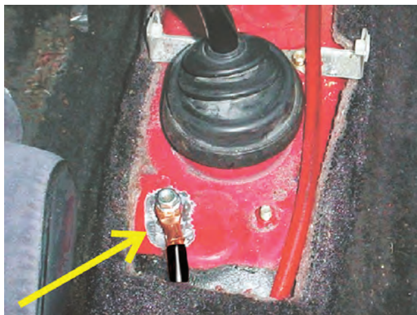
شکل ۲-۲۵- اتصال بدنه‌ی باتری در داخل اتاق خودرو
