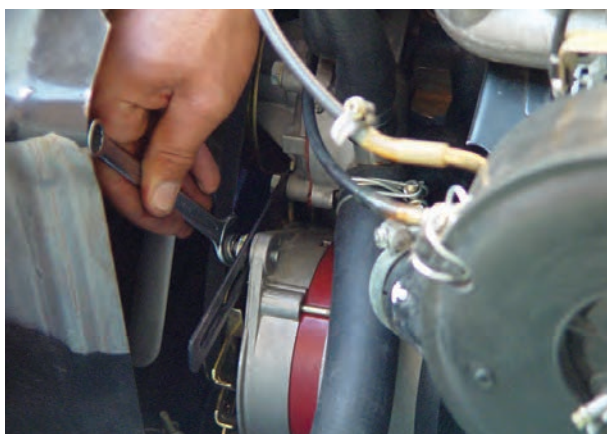
شکل ۷-۴۹ - باز کردن پیچ کشش تسمه پروانه
