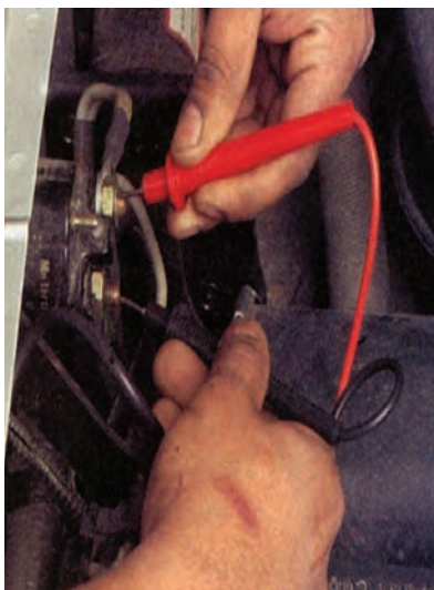
شکل ۸-۴۲ اتصال فیش‌های ولت‌متر به اتومات استارتر
