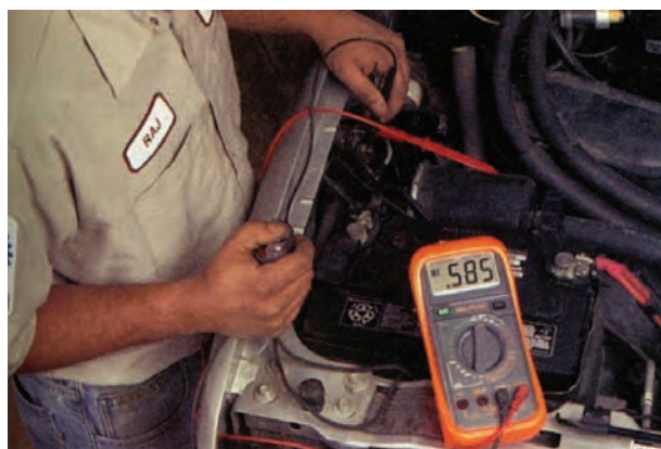
شکل ۸-۴۴ اندازه‌گیری افت ولتاژ پلاتین‌های سولونوید استارتر
