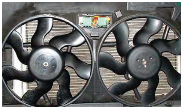
شکل ۱۴-۵- فن‌های نصب شده در روی رادیاتور یک نوع خودرو
