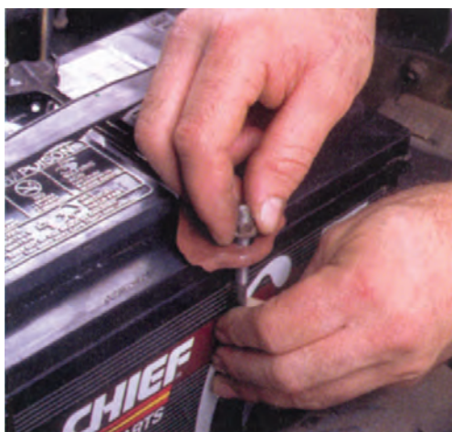
شکل ۹۴-۱- بستن باتری روی خودرو
