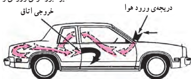
شکل ۴-۱۱- مسیر عبور جریان هوای گرم در خودرو
