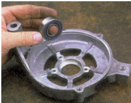
شکل ۷۰-۷ - خارج کردن بلبرینگ و آزمایش آن
