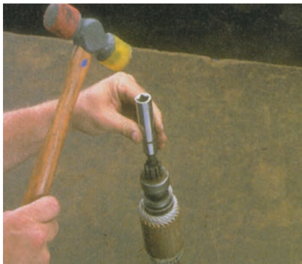
شکل ۸-۵۹ – ضربه زدن با چکش روی خار
