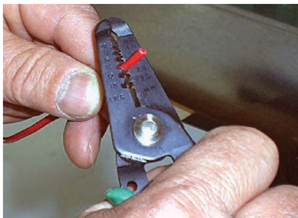
شکل ۶-۳۰ جدا کردن عایق سیم
